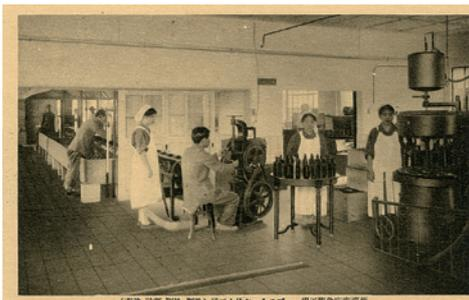
藤澤商店化学工場：補血強壯剤製造の仕上げ工程。洗瓶、検瓶、瓶詰、消毒
